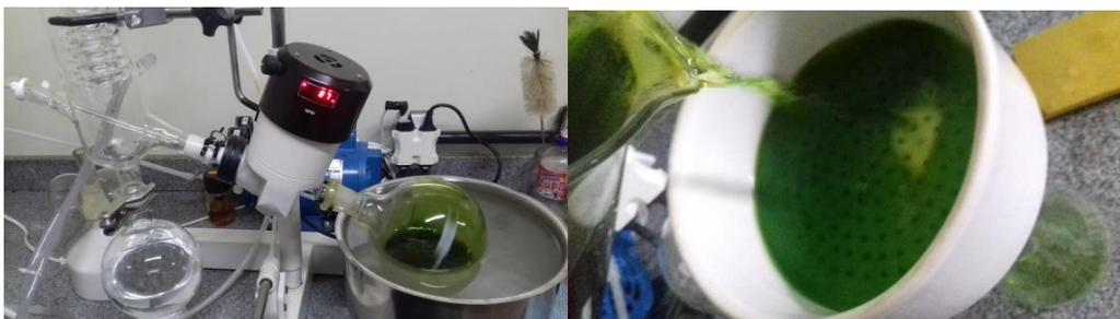
Figura 2. Rotoevaporação e separação dos extratos etanólicos no Lacibs, UFT campus de Palmas. Fotos ilustrativas. Fotografadas pelo autor.
