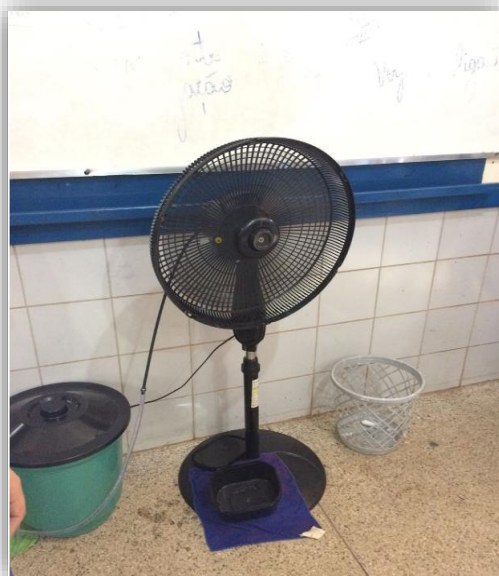
Figura 6 - Primeira versão do protótipo do umidificador de baixo custo
