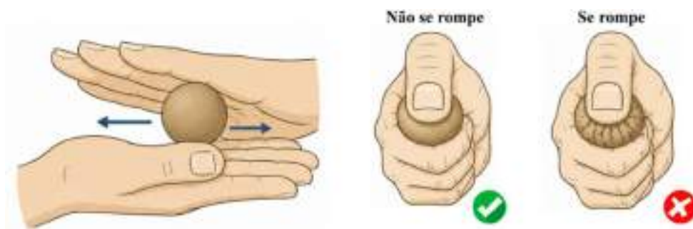
Figura 12 – Teste da bolinha para avaliação da coesão do solo
