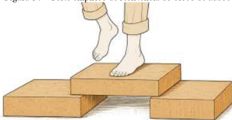
Figura 14 – Teste empírico de resistência do bloco de adobe
