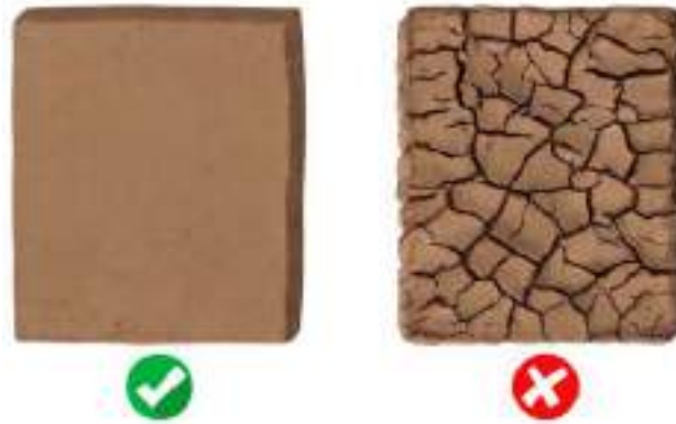
Figura 13 – Teste de fissuras por secagem em placas de terra crua
