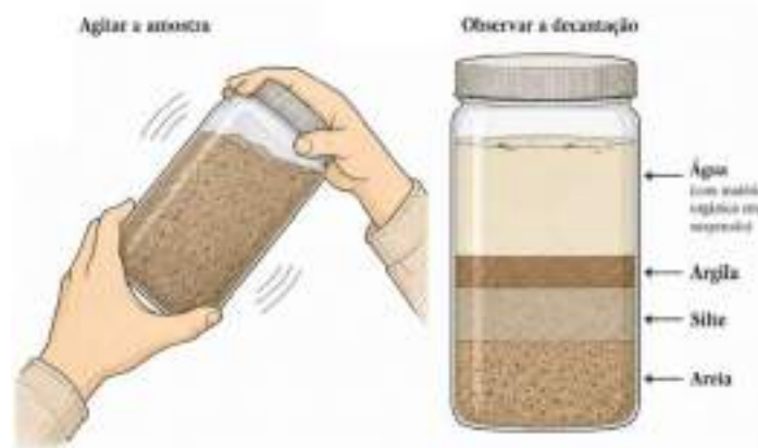
Figura 9 – Teste de sedimentação para caracterização expedita do solo
