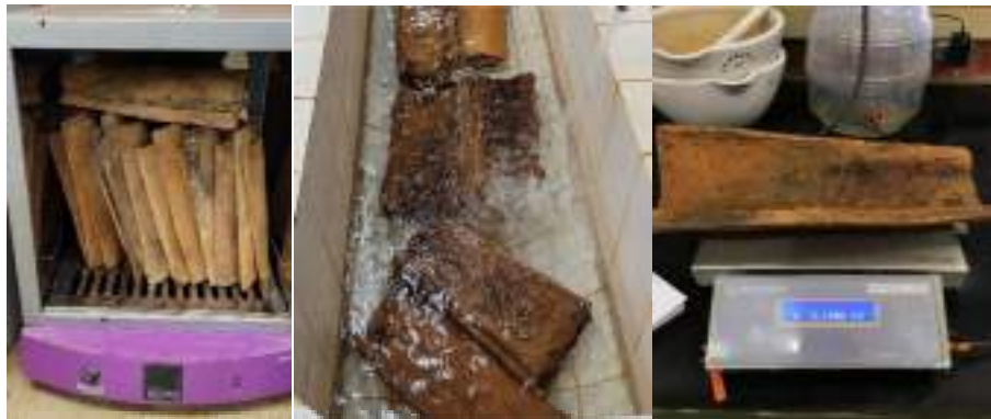
Figura 29 – Ensaio de absorção de água
