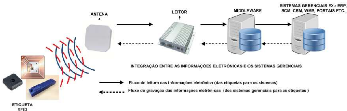
Figura 2 - Funcionamento de um sistema RFID
