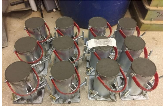
Figura 4: Corpos de prova recém moldados do traço de 10%.
