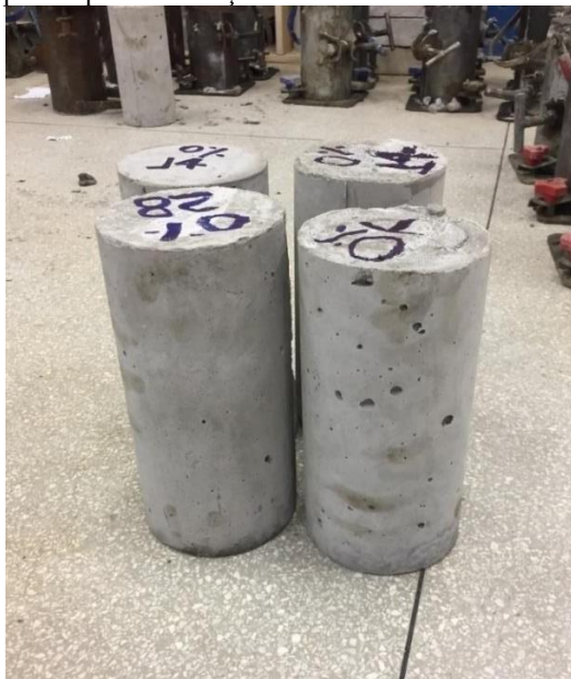
Figura 5: Corpos de prova do traço referência momentos antes da cura úmida.
