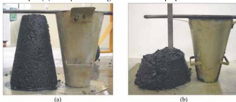
Figura 10: Ensaio de abatimento do tronco de cone para concreto de 20% de cinza ultrafina da casca antes (a) e após (b) correção da dosagem do aditivo superplastificante.
