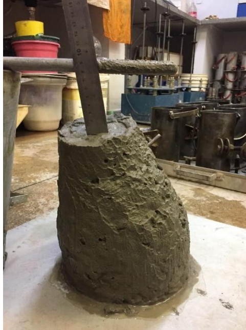
Figura 11: Medição ensaio de abatimento.
