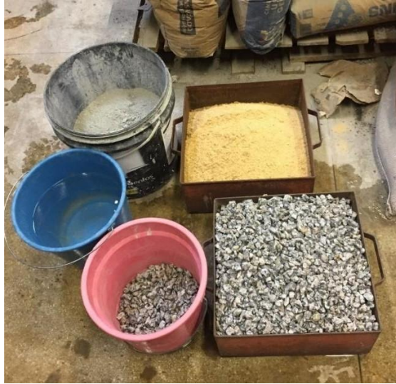
Figura 3: Materiais devidamente pesados e armazenados para execução do traço.
