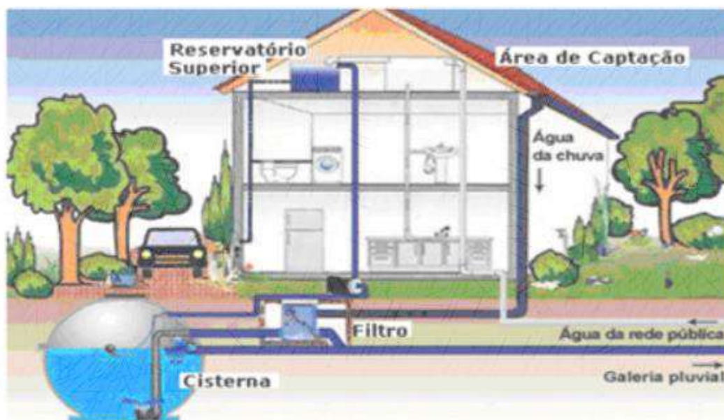
Figura 43: Elementos do sistema de captação de água pluvial.
