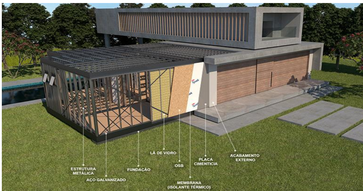
Figura 10 - Fechamento da face externa de uma parede em Steel Frame
