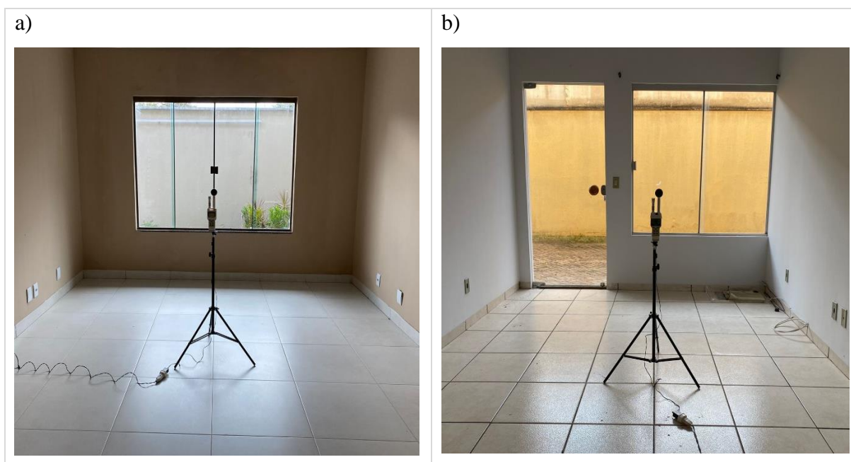
Figura 42 - a) Instalação do Termômetro na residência de Steel Frame e b) Instalação do Termômetro na residência de Alvenaria Convencional
