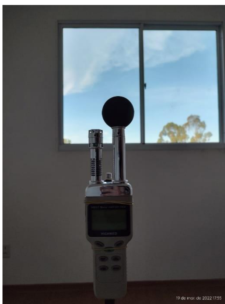
Figura 20 Termômetro instalado na edificação em Parede de Concreto
