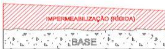
Figura 4 - Camadas da impermeabilização rígida.
