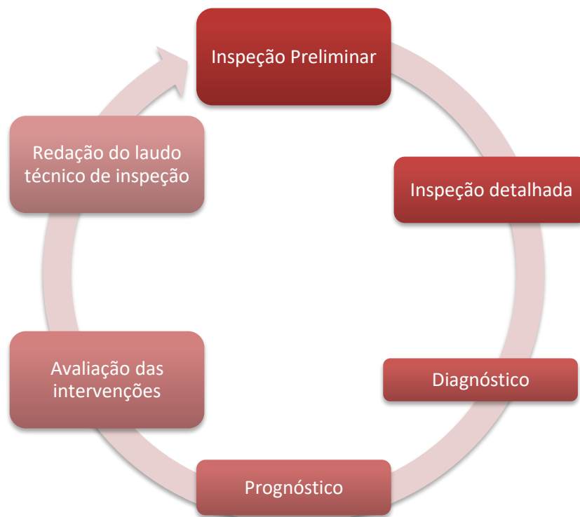
Figura 7 - Fluxograma da metodologia de inspeção predial.
