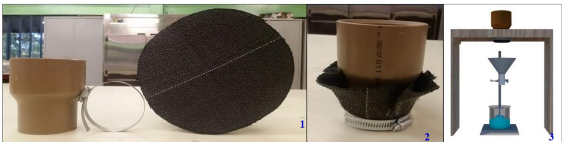
Figura 21 - Sistema de ensaio de bancada de filtração em tubo geotêxtil
