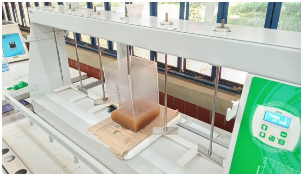
Figura 19 – Lodo sendo misturado ao condicionante químico no JarTest
