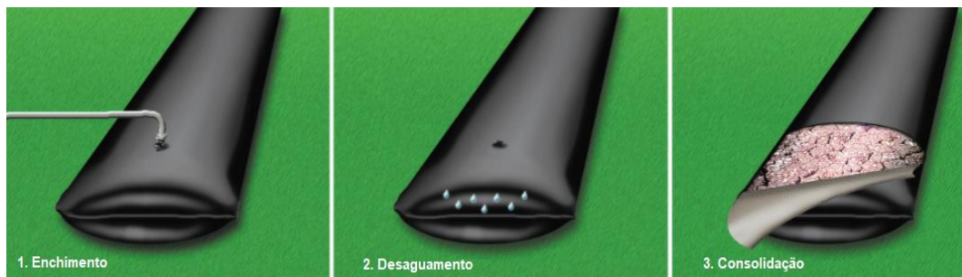
Figura 11 - Etapas do processo de desaguamento do lodo
