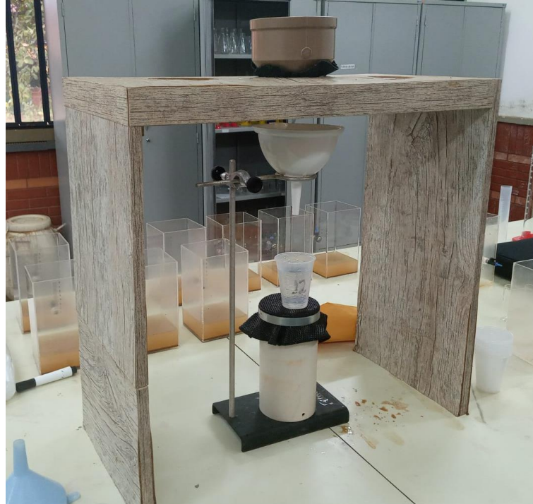
Figura 20 – Sistema de ensaio de bancada de filtração em tubo geotêxtil
