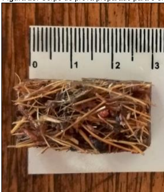
Figura 23: Corpo de prova preparado para o ensaio de densidade
