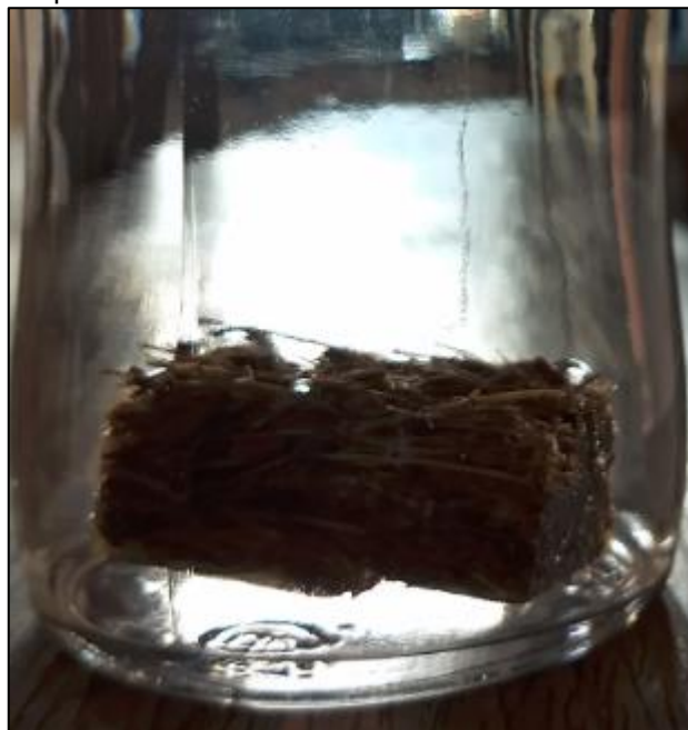
Figura 27: Ensaio de absorção de água em material compósito.
