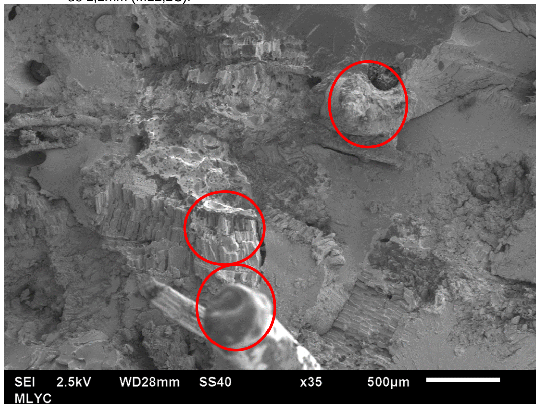
Figura 30: Microscopia eletrônica de varredura do material compósito com fibras lavadas de 1,2mm (ML1,2C).
