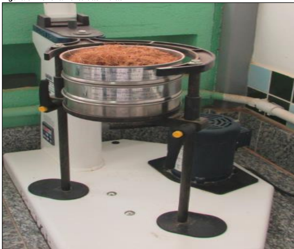
Figura 9: Peneiramento das Fibras.
