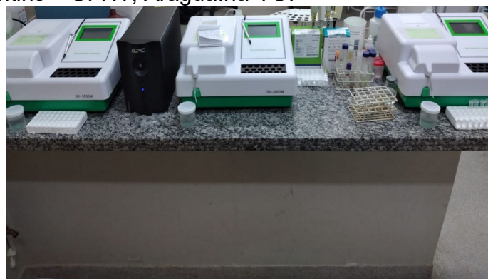
Figura 3 - Analisadores bioquímicos semiautomáticos SX-3000 pertencentes ao Laboratório de Patologia Clínica Veterinária (LPCV) da Clínica Veterinária Universitária (CVU) do Centro de Ciências Agrárias (CCA) da Universidade Federal do Norte do Tocantins – UFNT, Araguaína-TO.
