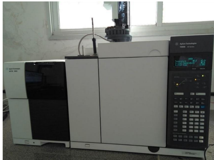
Figura 10 - Injeção manual da amostra com a fibra MEFS no CG-EM
