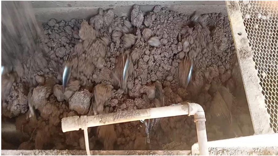
Figura 4: Argila passando pelas hélices e sendo molhada
