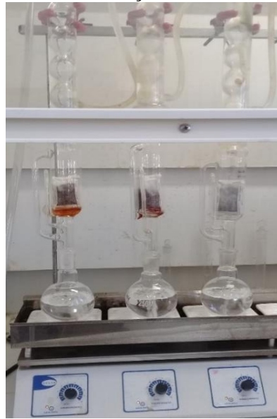
Figura 6 - Processo de extração com etanol e tolueno (1:2)
