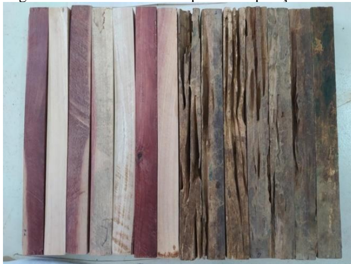
Figura 3 - Madeira antes e depois da exposição ao solo
