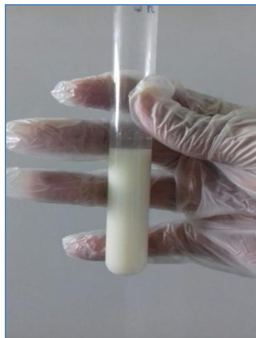
Figura 16 – Teste do amido negativo – Doces Pioneiro, 2017.
