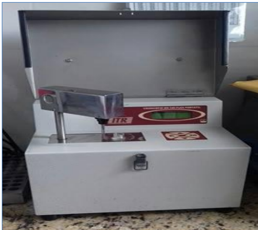
Figura 10 – Crioscópio eletrônico, que observa a temperatura de congelamento do leite – Doces Pioneiro, 2017.
