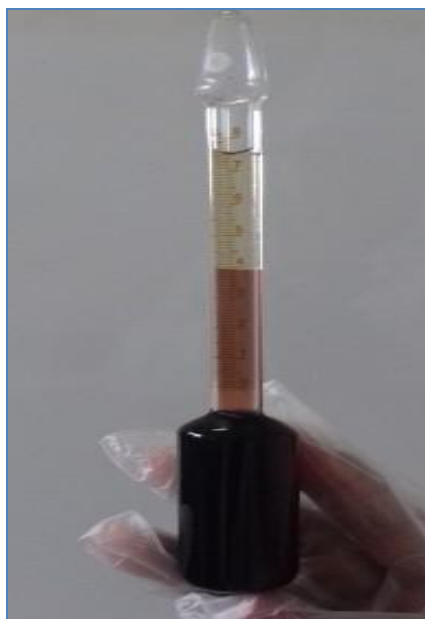
Figura 7 – Análise do teor de gordura realizado pelo Butirômetro – Doces Pioneiro, 2017.
