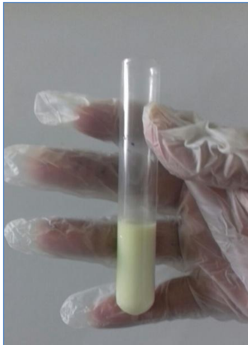
Figura 17 – Teste do hidróxido de sódio negativo – Doces Pioneiro, 2017.
