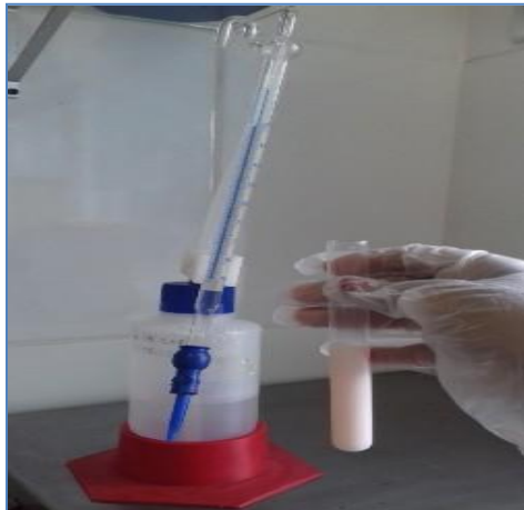
Figura 5 - Teste de acidez DORNIC – Doces Pioneiro, 2017.
