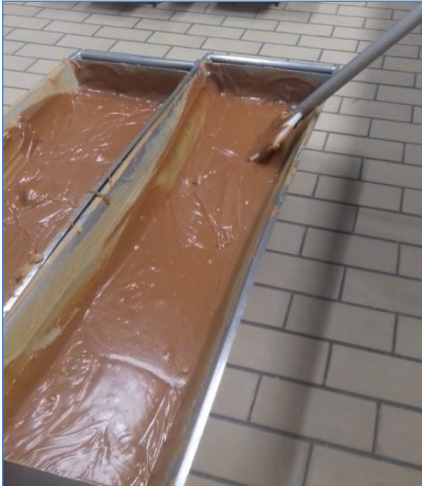
Figura 22 – Gamelas de aço inox, que leva o doce de barra para o corte – Doces Pioneiro, 2017.
