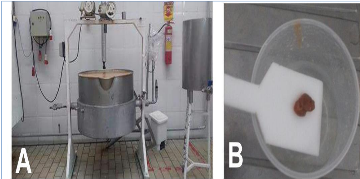
Figura 20 – Tachos de aço inox, onde era realizado o processo de concentração (A) e ponto do doce (B) – Doces Pioneiro 2017.
