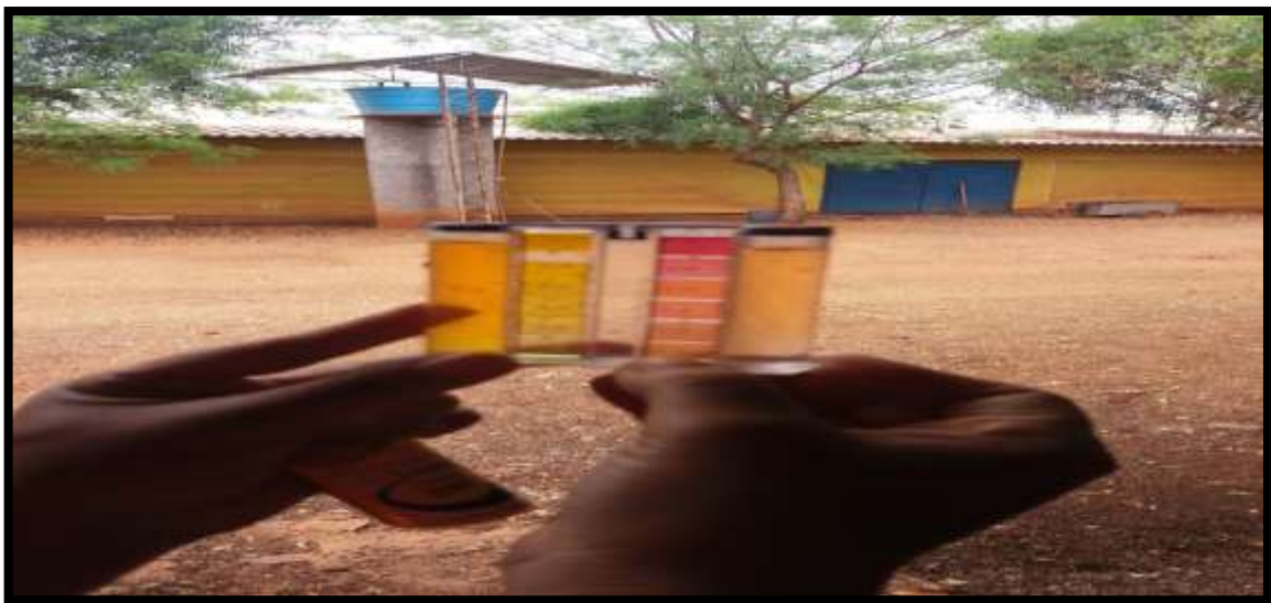
Figura 12 - Medidor de cloro.
