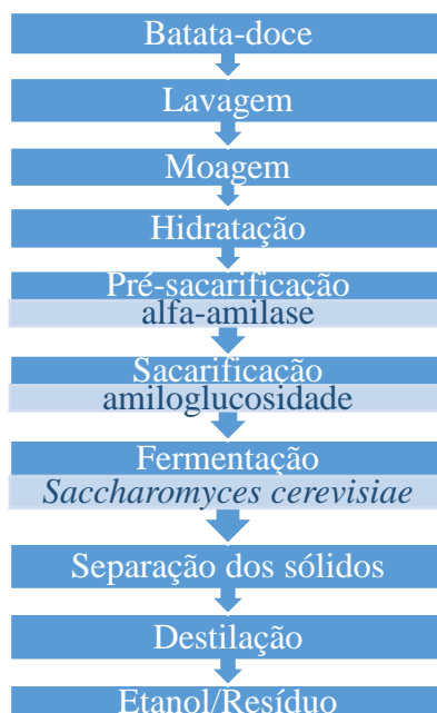
Figura 3 – Fluxograma do processo de obtenção do etanol a partir da batata-doce.
