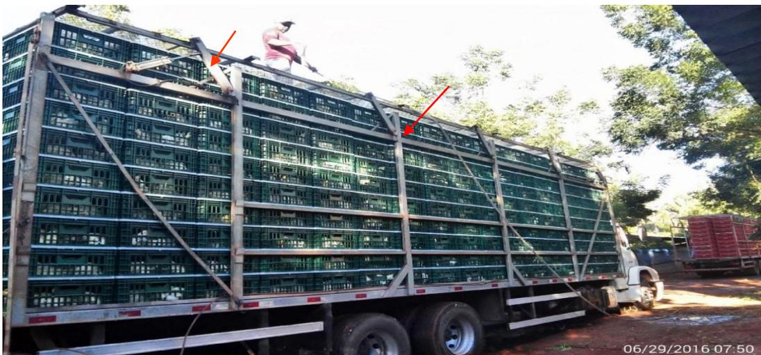
Figura 9: Caminhão com proteção para segurança da carga viva. Fonte: Próprio autor
