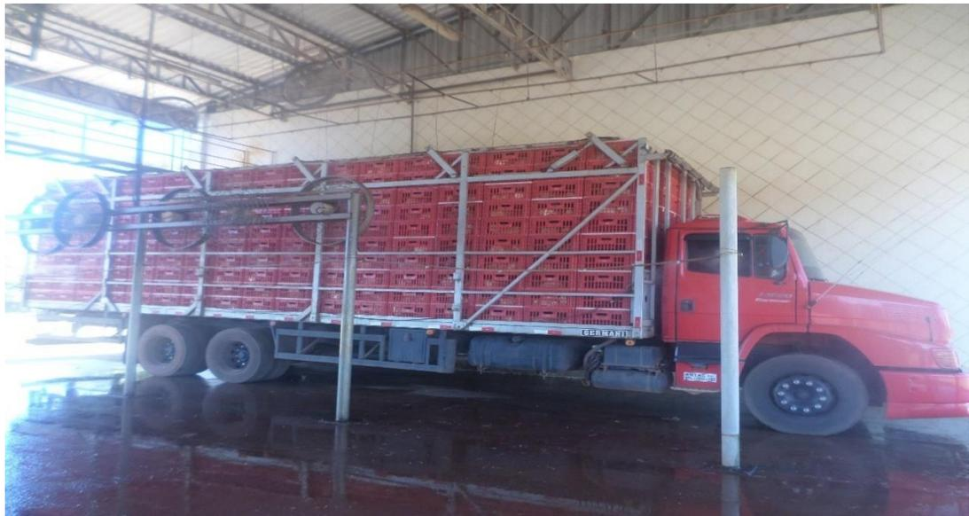
Figura 11: Caminhão estacionado no galpão de espera com sistema de nebulização e ventiladores. Fonte: Próprio autor.
