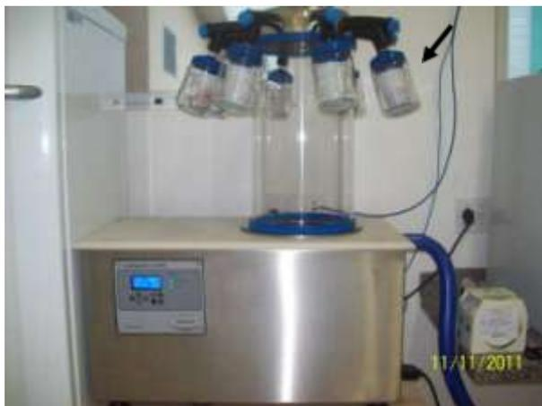
**Figura 11** – Liofilizador utilizado na secagem do extrato. Na parte indicada pela seta está a amostra de extrato a ser liofilizada (fonte: arquivo pessoal).
