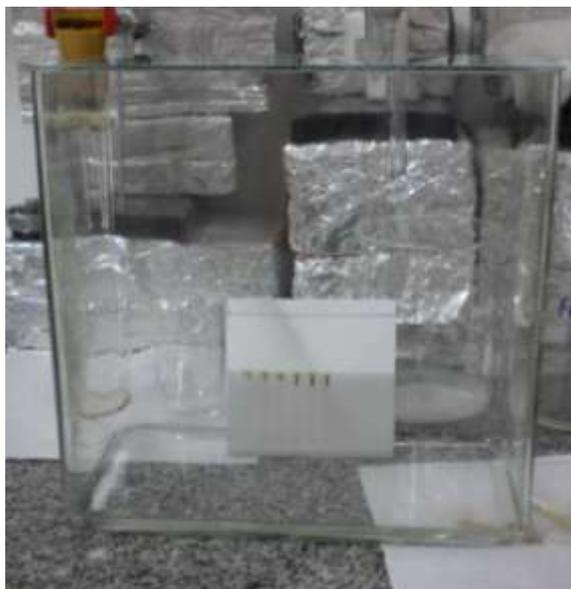
**Figura 13** – Desenvolvimento da cromatografia em camada delgada com os extratos de *I. batatas* e o padrão de referencia rutina (fonte: arquivo pessoal).
