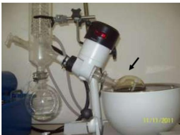
**Figura 10** – Concentração do extrato em rotaevaporador. O recipiente indicado pela seta contém a solução hidroalcolica do extrato (fonte: arquivo pessoal).
