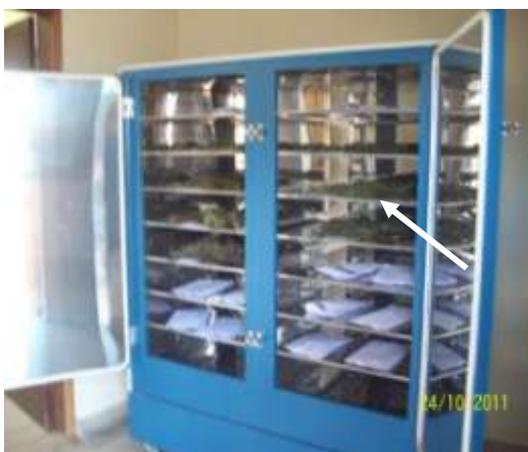
**Figura 8** – Secagem das folhas de *I. batatas* em estufa dotada de circulação de ar. Na parte indicada pela seta encontram-se as folhas e os pecíolos sendo secos (fonte: arquivo pessoal).
