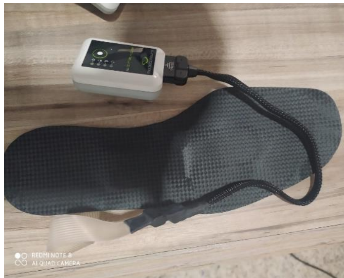
Figura 3 – Foto da palmilha eletrônica para o pé direito
