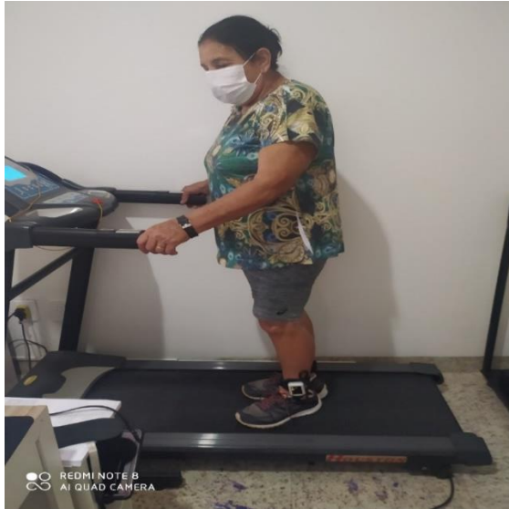
Figura 6 – Paciente na esteira para teste de caminhada com o dispositivo W-Inshoe acoplado
