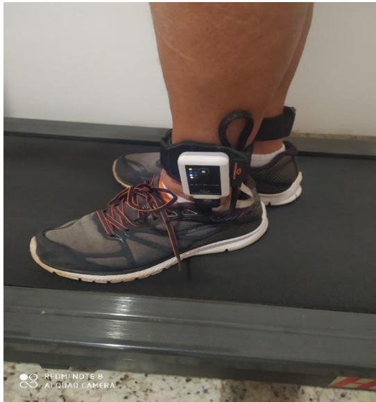
Figura 4 – Foto do dispositivo W-Inshoe acoplado no tornozelo e a palmilha eletrônica dentro do tênis
