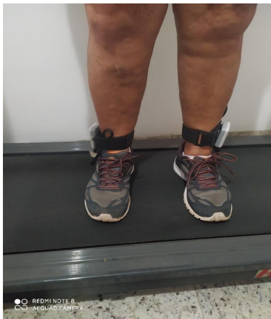
Figura 5 – Dispositivo W-Inshoe acoplado no tornozelo e palmilha eletrônica
