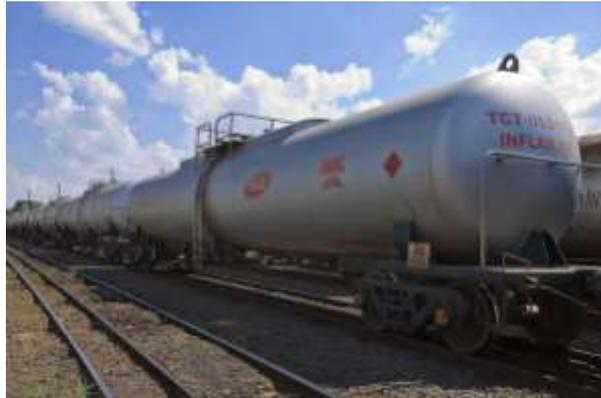
Figura 3.16 - Equipamento de transporte ferroviário, mostrando um vagão de granel líquido
