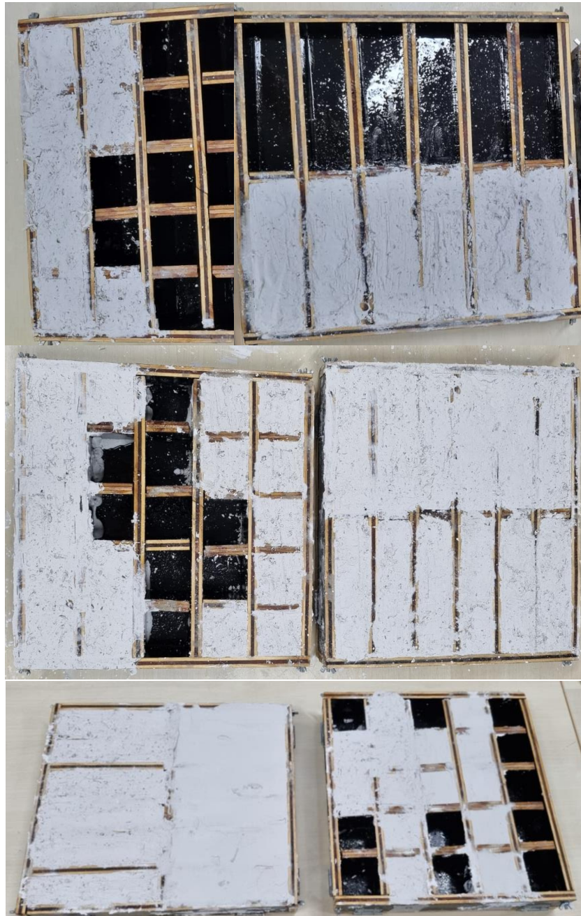
Figura 10 – Execução das Moldagens dos Espécimes dos Proporcionamentos do Material Compósito
