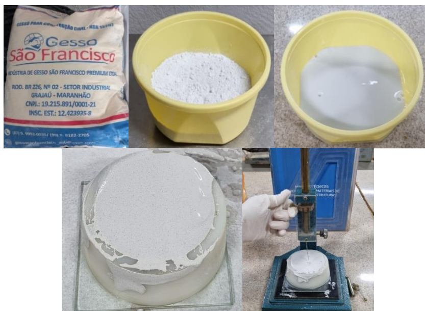
Figura 2 – Ensaio de Pega do Gesso
