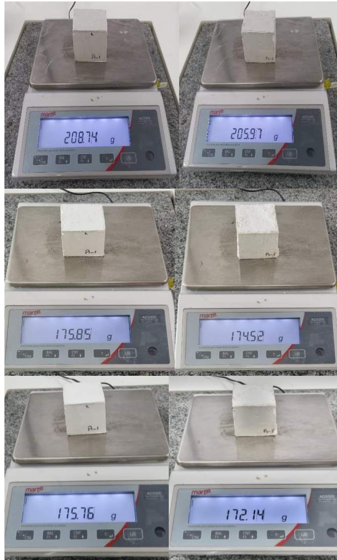
Figura 12 – Aferição das massas dos prismas P0V0 (esq.) e P1V5 (dir.) aos 1, 7 e 28 dias
