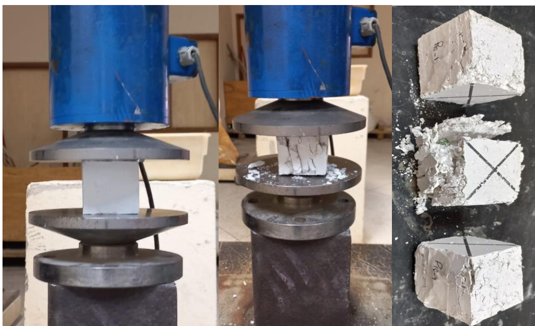
Figura 15 – Execução dos Ensaio de Resistência à Compressão Axial dos Proporcionamentos do Material Compósito
