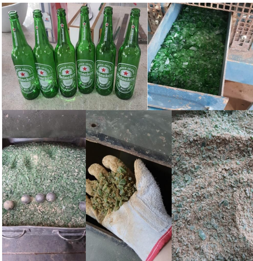
Figura 3 – Processo de Obtenção do Vidro Cominuído
