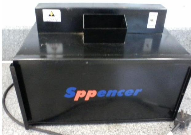
**Figura 8:** Câmara escura utilizada no processo de fotodegradação.
