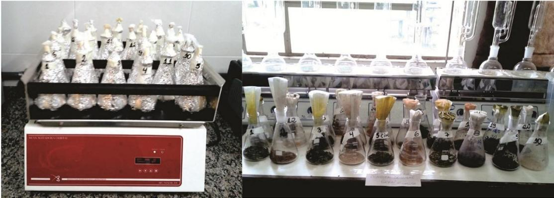
Figura 2: Extração por Maceração à Frio em Mesa Agitadora Orbital e extratos após 8 dias - (Fonte: Autora)
