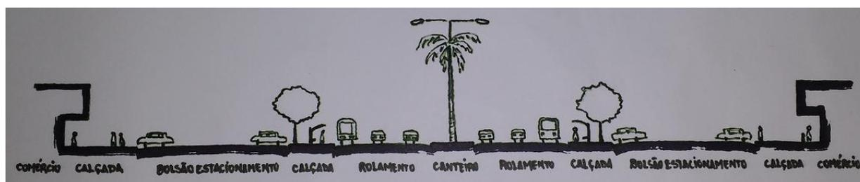
Figura 184 – Croqui do perfil da Av. J.K. com indicação da definição de funções de suas partes. Elaboração: autora (2015).
