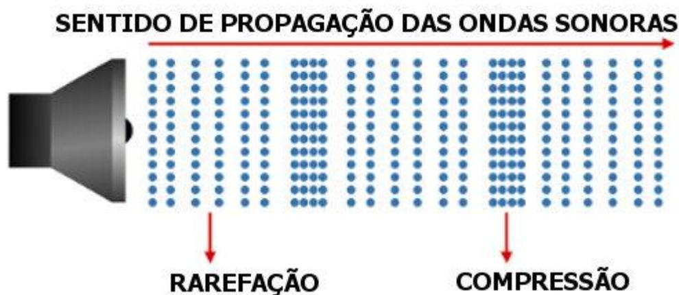
Figura 08: Sentido de propagação das ondas sonoras no ar.
