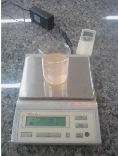
Figura 10: Foto do experimento para obter a densidade. Medida da massa da água. Fonte: Autoria Própria.
