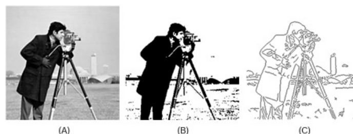
Figura 14 – Exemplo de duas abordagens para segmentação. (A) Imagem original em níveis de cinza. (B) Imagem segmentada através de uma binarização. (C) Imagem segmentada por detecção de bordas. FONTE: (PROCESSAMENTO, 2021)
