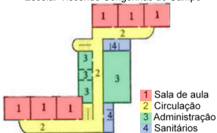
Figura 11 - Figura 11 - Planta Baixa do Nível Térreo do Grupo Escolar Visconde Congonhas do Campo
