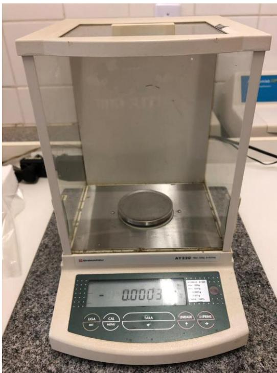
*Figura 4 – Balança analítica*
