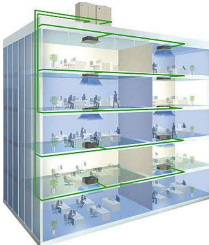
Figura 52. Sistema de distribuição do sistema VRF. Fonte: ArPlus
