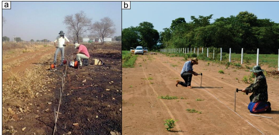
Figura – 30: Levantamentos de campo de geofísica, (a) Sondagem Elétrica Vertical e (b) Caminhamento Elétrico Dipolo-Dipolo.
