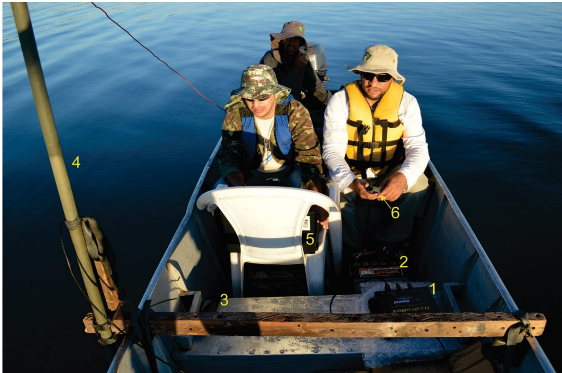
Figura – 27: Disposição do equipamento durante o levantamento batimétrico.
