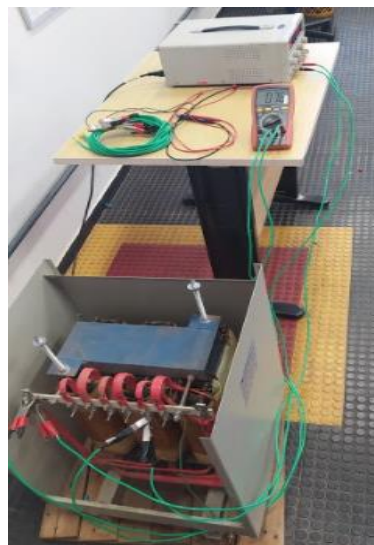
Figura 28 - Esquema de Ligação do Ensaio de Resistência Elétrica
