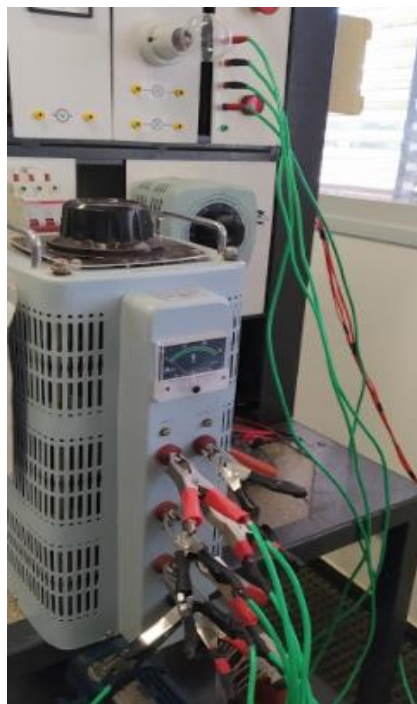
Figura 17 - Ligação entre a Bancada e o Variador de Tensão
