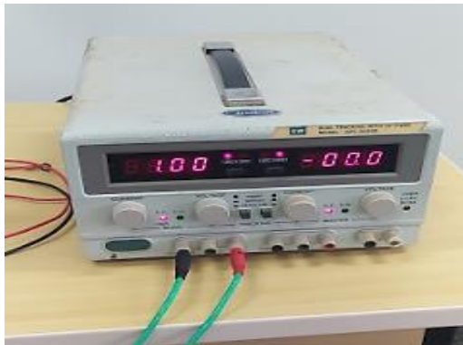
Figura 26 - Fonte de Alimentação GW GPC-3020D ajustada em 1 A
