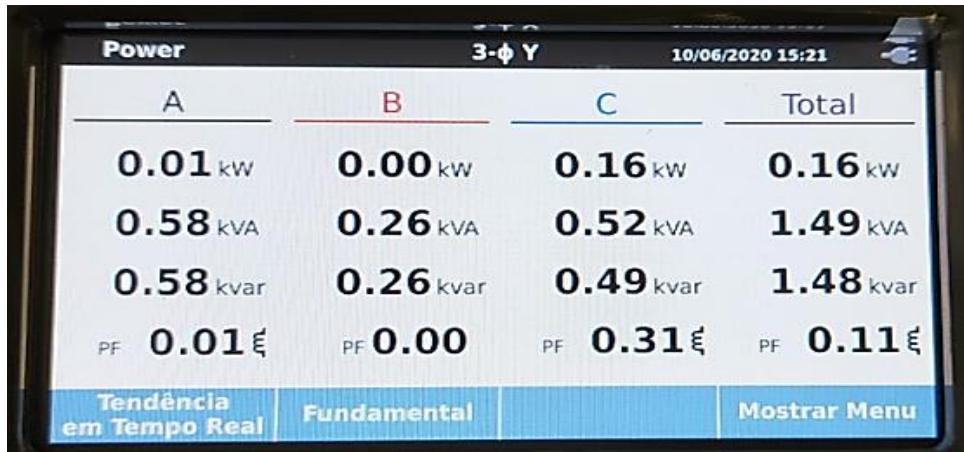
Figura 21 - Valores de Potência e Fator de Potência do Ensaio a Vazio
