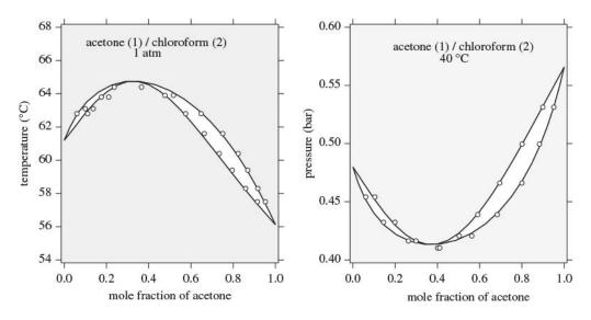
Figura 2 - Misturas Azeotrópicas com Ponto de Ebulição Máximo
