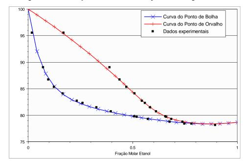
Figura 20 - Simulação do modelo NRTL para etanol-água a 1 atm
