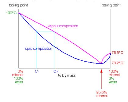
Figura 8 - Ponto de ebulição - diagrama de composição para o sistema etanol-água
