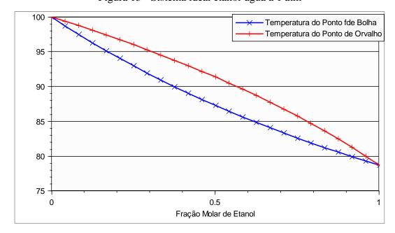
Figura 13 - Sistema ideal etanol-água a 1 atm
