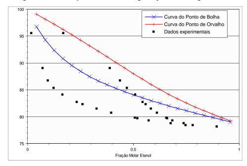
Figura 17 - Simulação do modelo Margules para etanol-água a 1 atm
