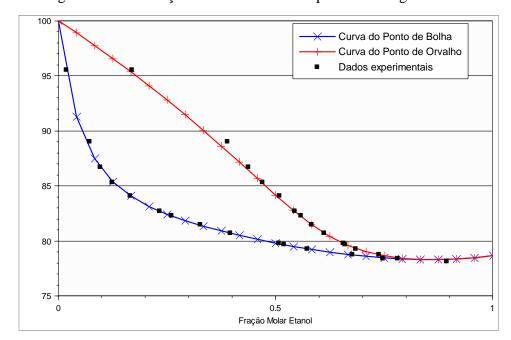
Figura 19 – Simulação do modelo Wilson para etanol-água a 1 atm
