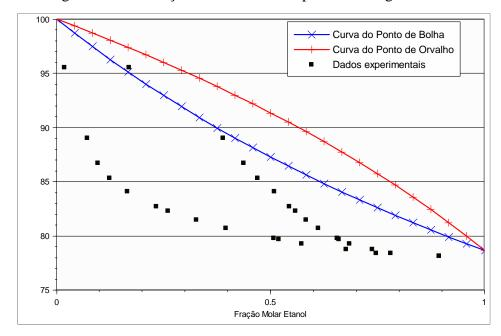
Figura 16 - Simulação do modelo ideal para etanol-água a 1 atm
