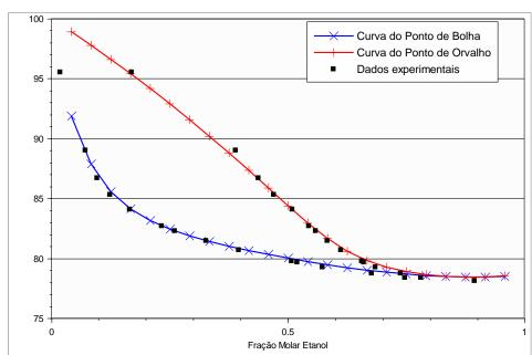
Figura 18 - Simulação do modelo Van Laar para etanol-água a 1 atm
