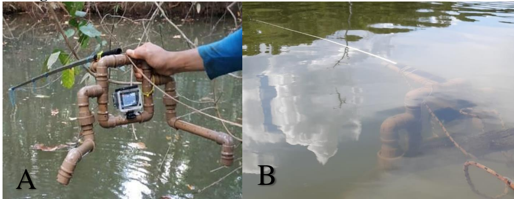
Figura 3: Estrutura da BRUV. A= BRUV emersa; B= BRUV submersa.
