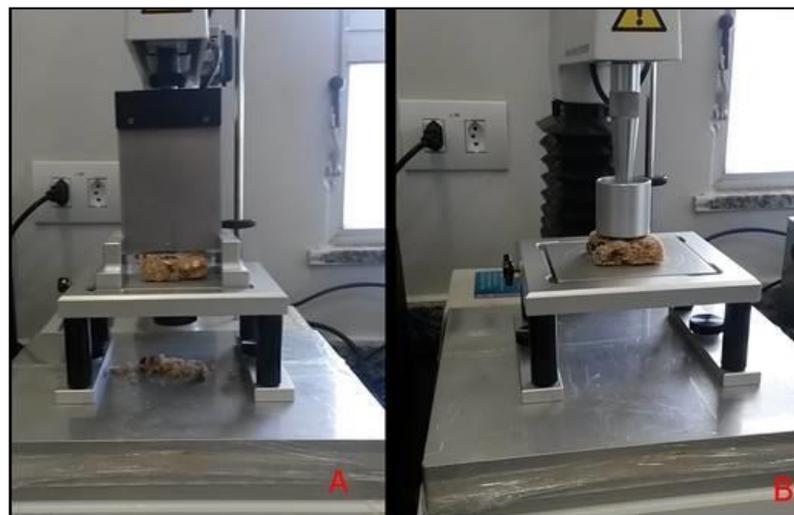
Figura 6: Em A - realização do teste de cisalhamento e em B - Análise do Perfil de Textura (TPA) com probe de 36mm.
