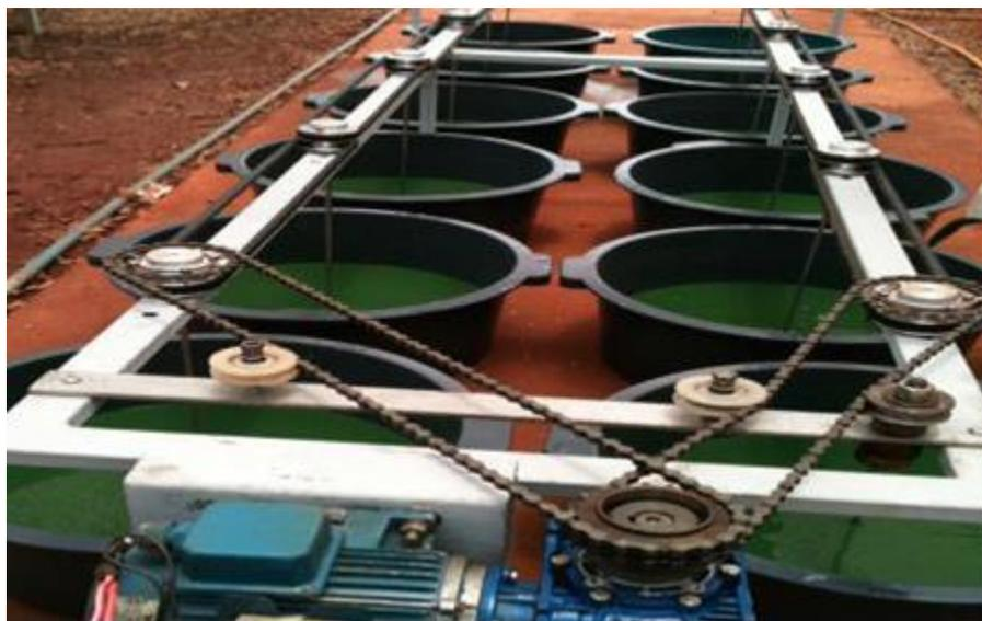
Figura 3: Sistema de cultivo utilizado para incorporação mineral na biomassa de *A. platensis*.
