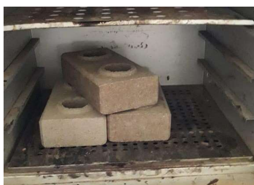
Figura 43: Secagem dos tijolos do traço TJ20-40 em estufa para obtenção da massa seca.
