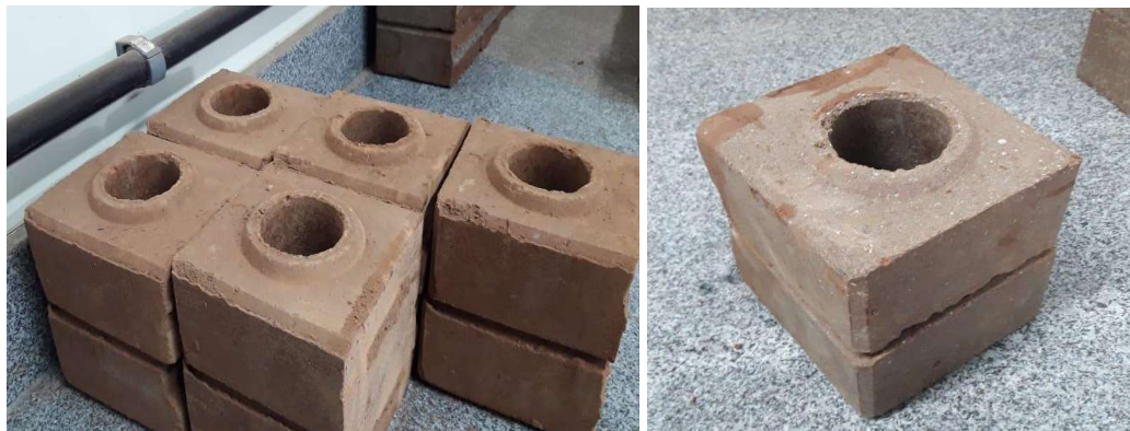
Figura 46: Corte dos tijolos para a preparação do capeamento e ensaio a compressão. (a) 5 Tijolos do traço TJ20-20 e (b) Tijolo do traço TJ20-30.
