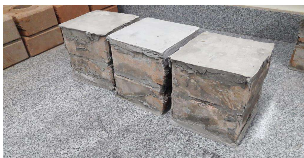
Figura 47: Capeamentos dos tijolos de solo-cimento com pasta de cimento CP-IV.
