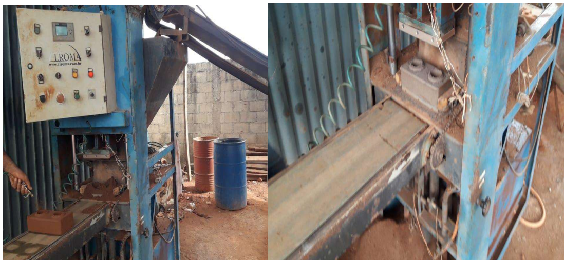
Figura 39: Prensa hidráulica de produção do tijolo de solo-cimento
