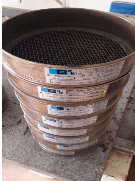
Figura 32: Série de peneiras utilizadas para o peneiramento fino.
