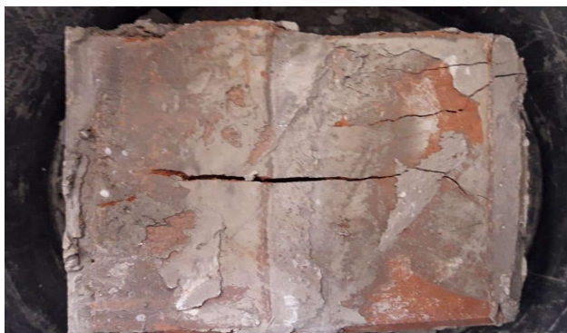
Figura 49: Tijolo rompido após o ensaio de compressão axial.
