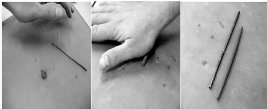
Figura 7: Ensaio de determinação do limite de plasticidade.
