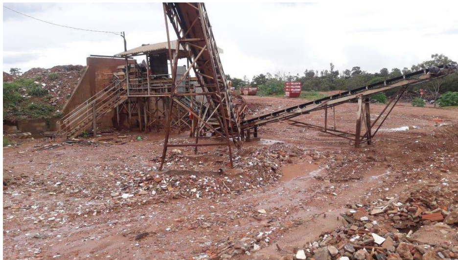
Figura 26: Usina de reciclagem de resíduos de construção civil Ambiental, Palmas-TO.
