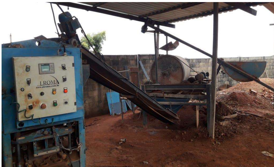
Figura 38: Conjunto peneira, esteira e prensa motorizada na fábrica de produção do tijolo de solo cimento.
