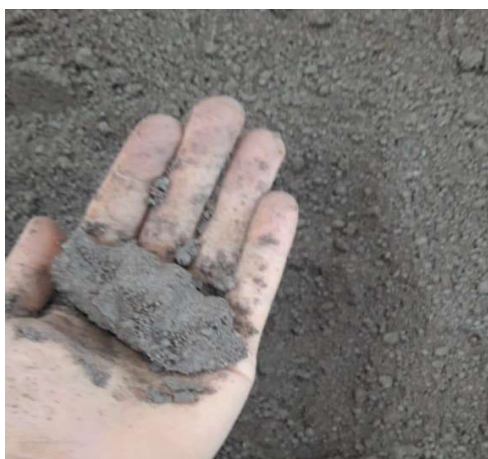
Figura 37: Realização do ensaio tátil-visual.
