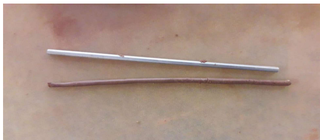
Figura 34: Ensaio do limite de plasticidade do Solo A no laboratório de solos da UFT.
