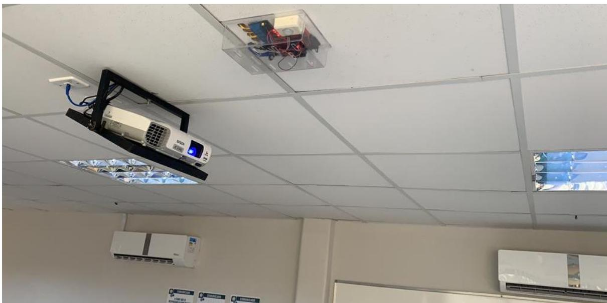
Na Figura 28, a visão inferior que contempla o protótipo em uma caixa de proteção acrílica medindo 13,5 centímetros largura, 20,5 centímetros de altura e 5 centímetros de profundidade, servindo para proteção de conectores e placas anexadas ao protótipo, essa caixa fica anexada a uma placa do forro de gesso e pode ser removida para ajustes e manobras.
