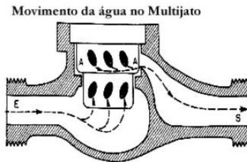
Figura 9: Movimento da Água em hidrômetro Multijato. (Fonte: DA SILVA, N. R., 2008)
