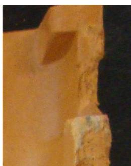
e) Telha com trincas e lascas
