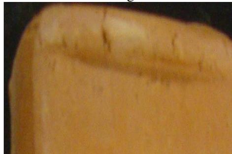
b) Telha com fissura
