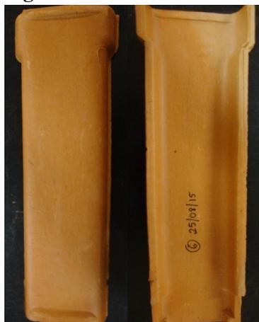
A Figura 26 apresenta as telhas produzidas com 10% de lodo de ETA no período chuvoso e de estiagem e alguns aspectos observados conforme NBR 15310 (ABNT, 2005)
