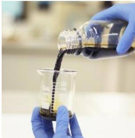
**Figura 5:** Bio-óleo obtido do processo de pirólise do lodo de esgoto
