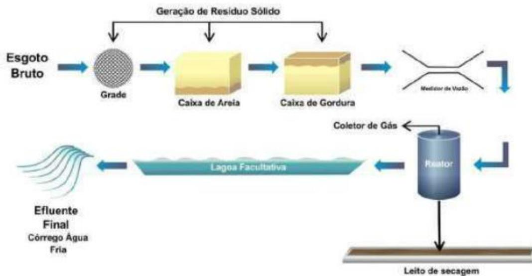
**Figura 3:** Diagrama de funcionamento de uma ETE (Estação de Tratamento de Esgotos) localizada em Palmas-TO
