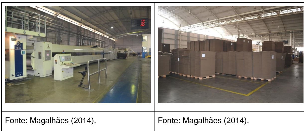
Figura 113 - Secadora e pátio de armazenamento de chapas.
