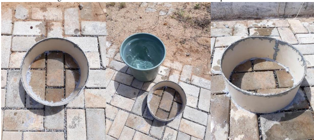
Figura 27 – Procedimento de ensaio de coeficiente de permeabilidade.
