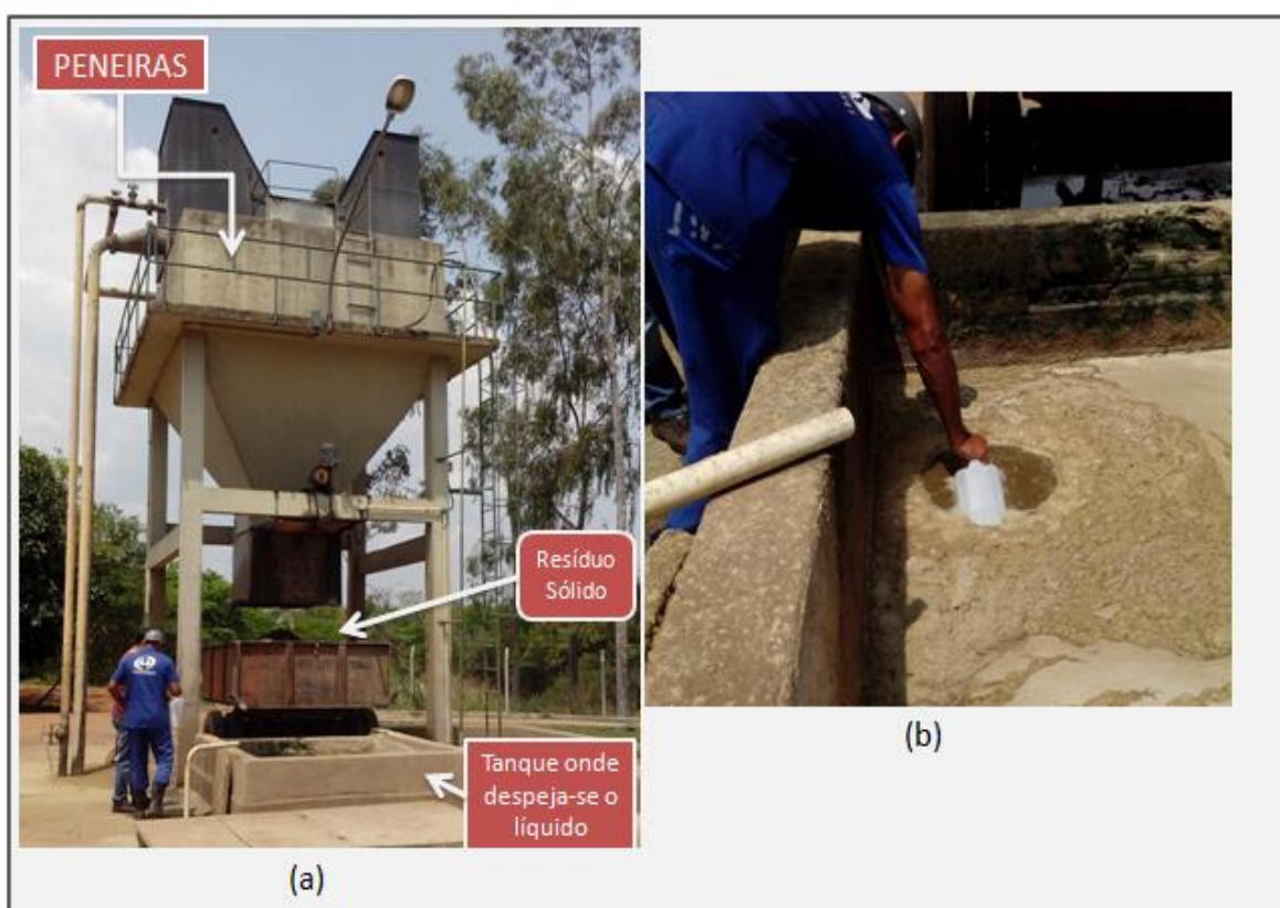
FIGURA 10 - (a) detalhe da peneira hidrodinâmica de separação do conteúdo da Linha Verde, todo o resíduo entra na estrutura, e na “carretinha” coleta-se a parte sólida que segue para compostagem e no tanque (que está em constante movimentação) recolhe-se o conteúdo líquido; (b) coleta do resíduo líquido.
