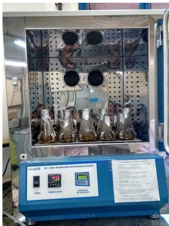
FIGURA 12 - Detalhe da Incubadora refrigerada Shaker no início da hidrólise. FONTE: próprio autor.
