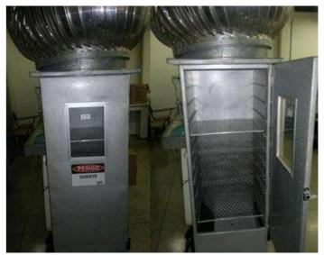
Figura 4.2 – Desidratador misto, do tipo eílico solar/convencional
