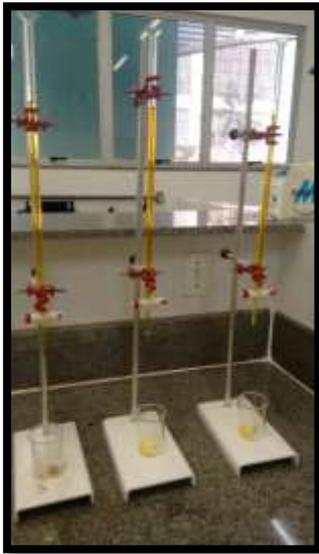
**Figura 5** - Buretas utilizadas na determinação de viscosidade
