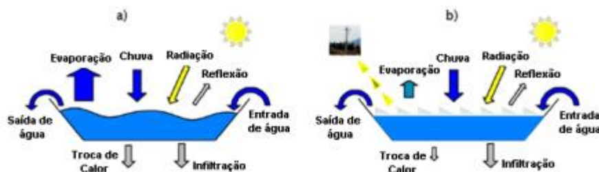
Figura 17- Esquema balanço água-energia.
