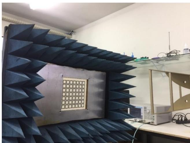
Figura 5.3. Setup para medição do  $S_{21}$ .
