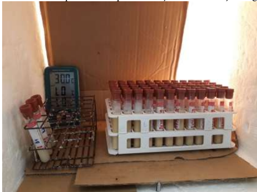
Figura 8 – Estufa “box” de isopor utilizada para realização da fermentação da glicose
