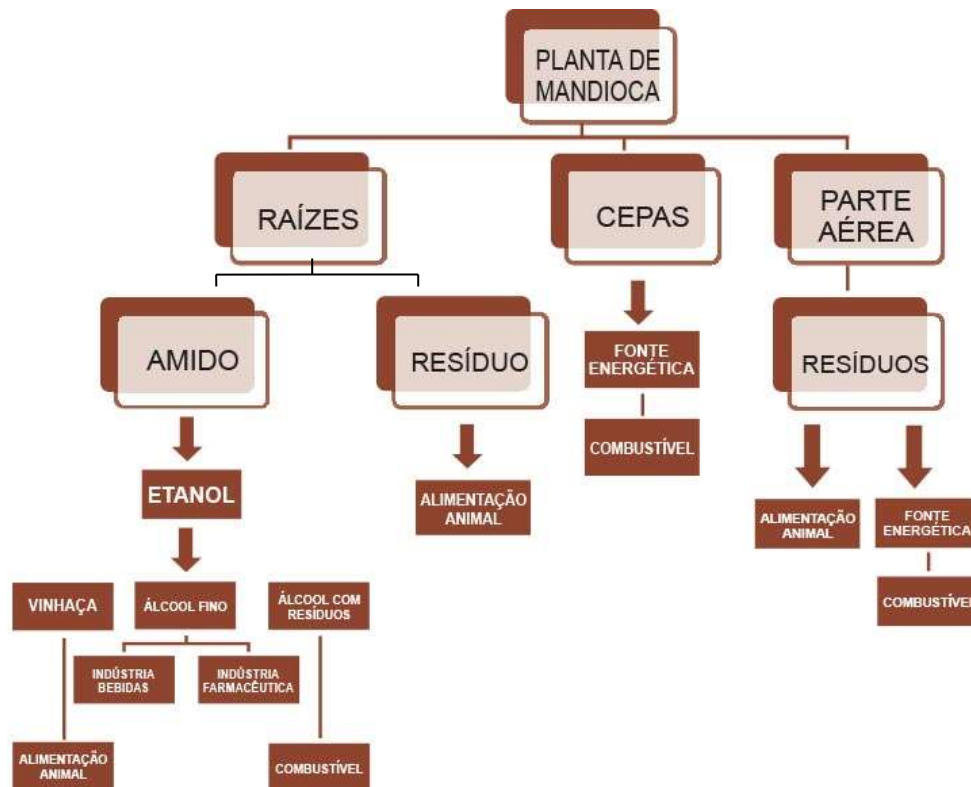
Figura 2 - Fluxograma da planta de mandioca com seus produtos principais e possibilidades de usos
