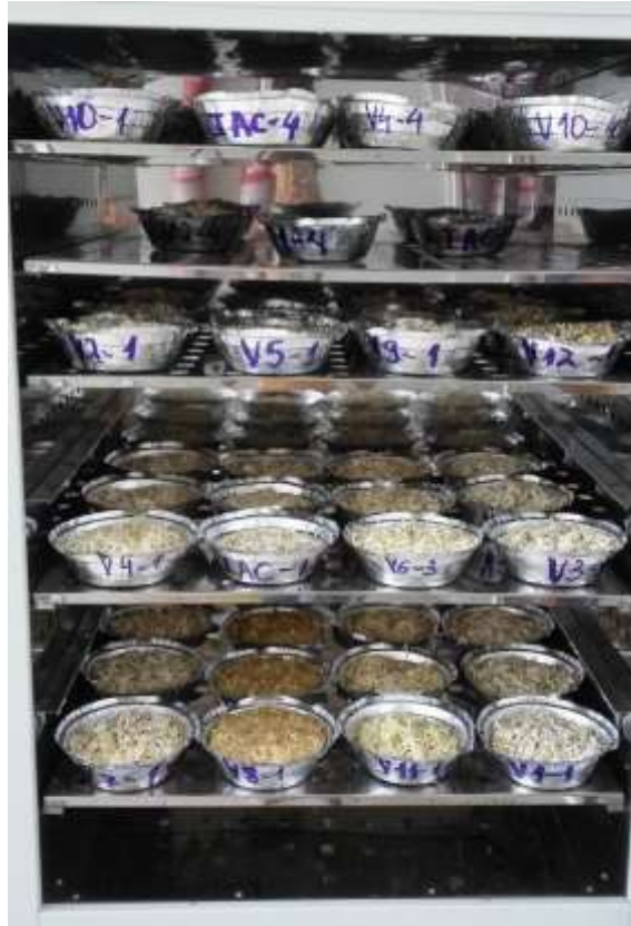
Figura 3 - Raízes raladas e acondicionadas em bandejas de alumínio, para secagem em estufa por 72 horas a 60°C
