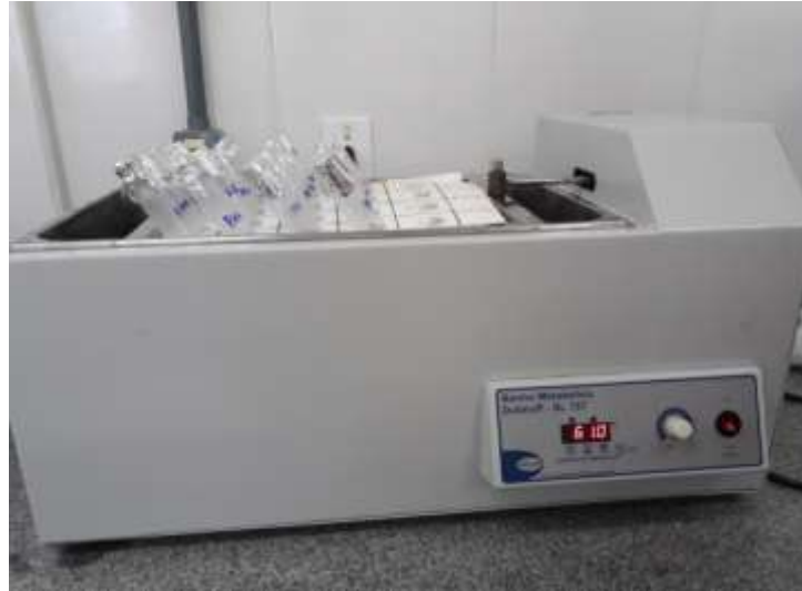
Figura 4 - Amostras sendo hidrolisadas com auxílio do banho metabólico
