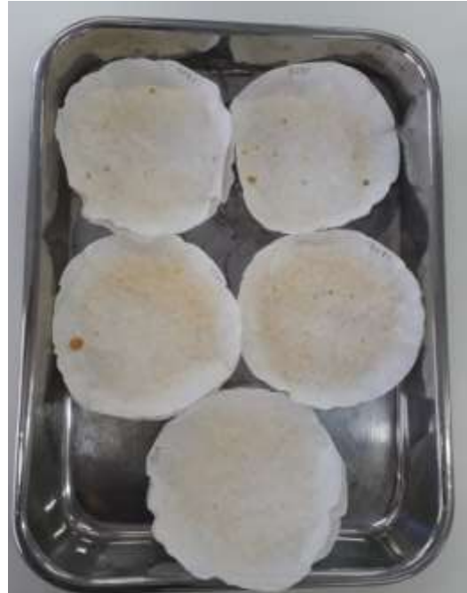
Figura 7 - Amostras filtradas com material retido no papel filtro
